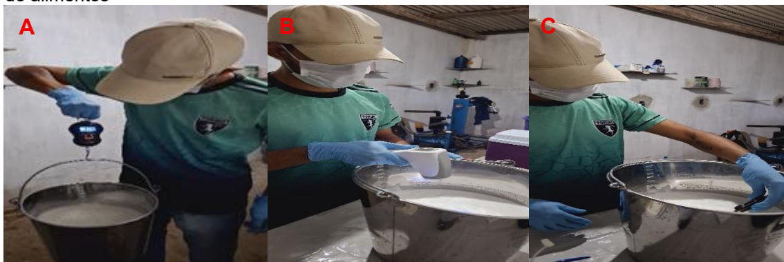
Figura 33 - Procedimento de coleta de dados. A - Pesagem do balde com leite. B - Aferição de temperatura do leite com o termômetro de laser. C - Aferição de temperatura do leite com o termômetro de alimentos
