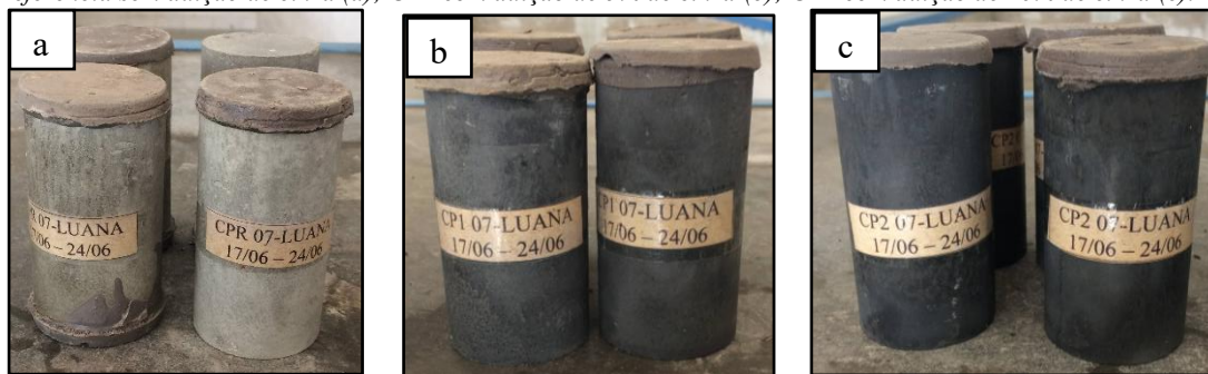
Figura 18 - Copo de Provas capeados para ensaios de resistências à compressão a idade de 7 dias: CPR de referência sem adição de cinza (a); CP1 com adição de 5% de cinza (b); CP2 com adição de 10% de cinza (c).
