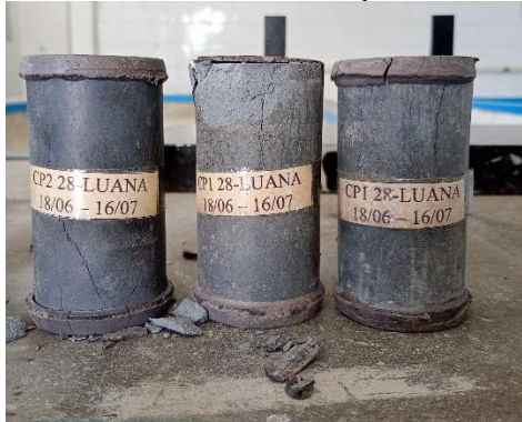
Figura 24 - Ensaio de resistência à compressão a idade de 28 dias.
