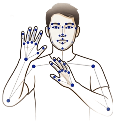
Figura 4.3: Extração dos keypoints com MediaPipe
