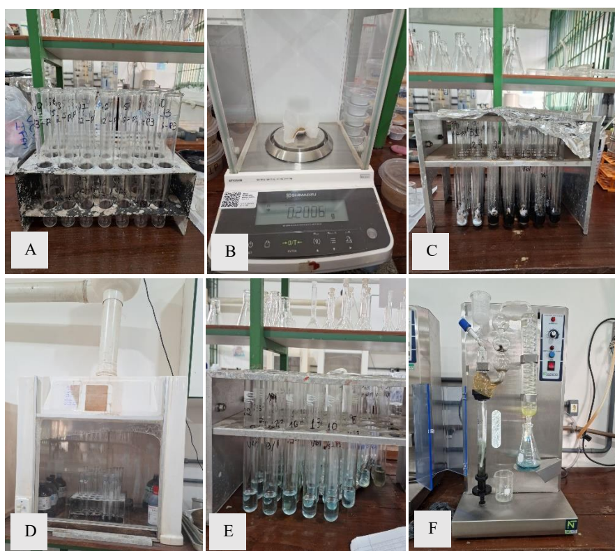
Figura 5. Materiais utilizados nas análises de proteína bruta (PB). (A) Tubo de ensaios devidamente identificados; (B) Peso das amostras em papel vegetal na balança analítica; (C) Tubo preparado com mistura catalítica e ácido sulfúrico; (D) Bloco digestor com as amostras pra digestão; (E) Amostras digeridas e (F) Destilador de nitrogênio.
