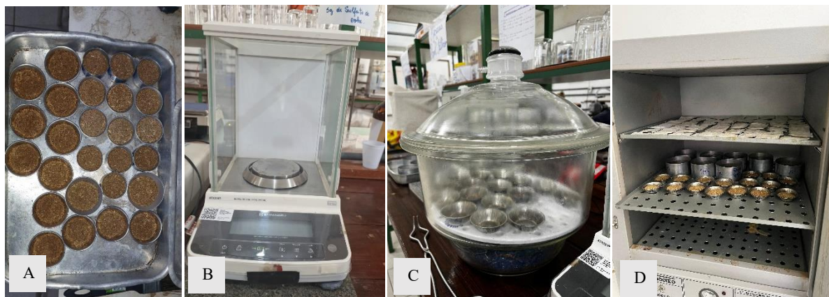
Figura 3. Materiais utilizados nas análises para determinação de Matéria Seca (MS). (A) Capsulas de alumínio com amostras; (B) balança analítica; (C) Dessecador com capsulas resfriando e (D) Amostras na estufa. Fonte: ANDRADE (2025); MELO (2025); RODRIGUES (2025).
