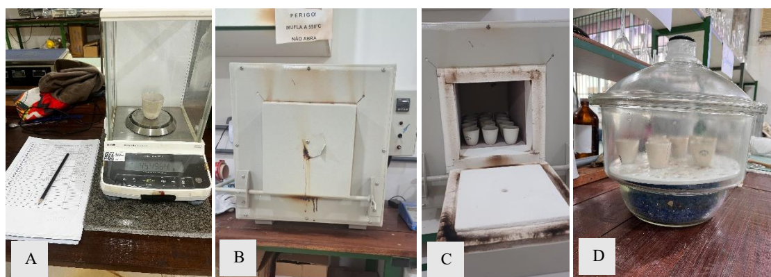
Figura 4. Materiais utilizados nas análises de cinzas das silagens. (A) Peso do cadinho em balança analítica; (B) Mufla de 550°C; (C) cadinhos mais amostras na mufla para aquecimento e (D) Cadinho com resíduo no dessecador. Fonte: ANDRADE (2025); MELO (2025); RODRIGUES (2025).
