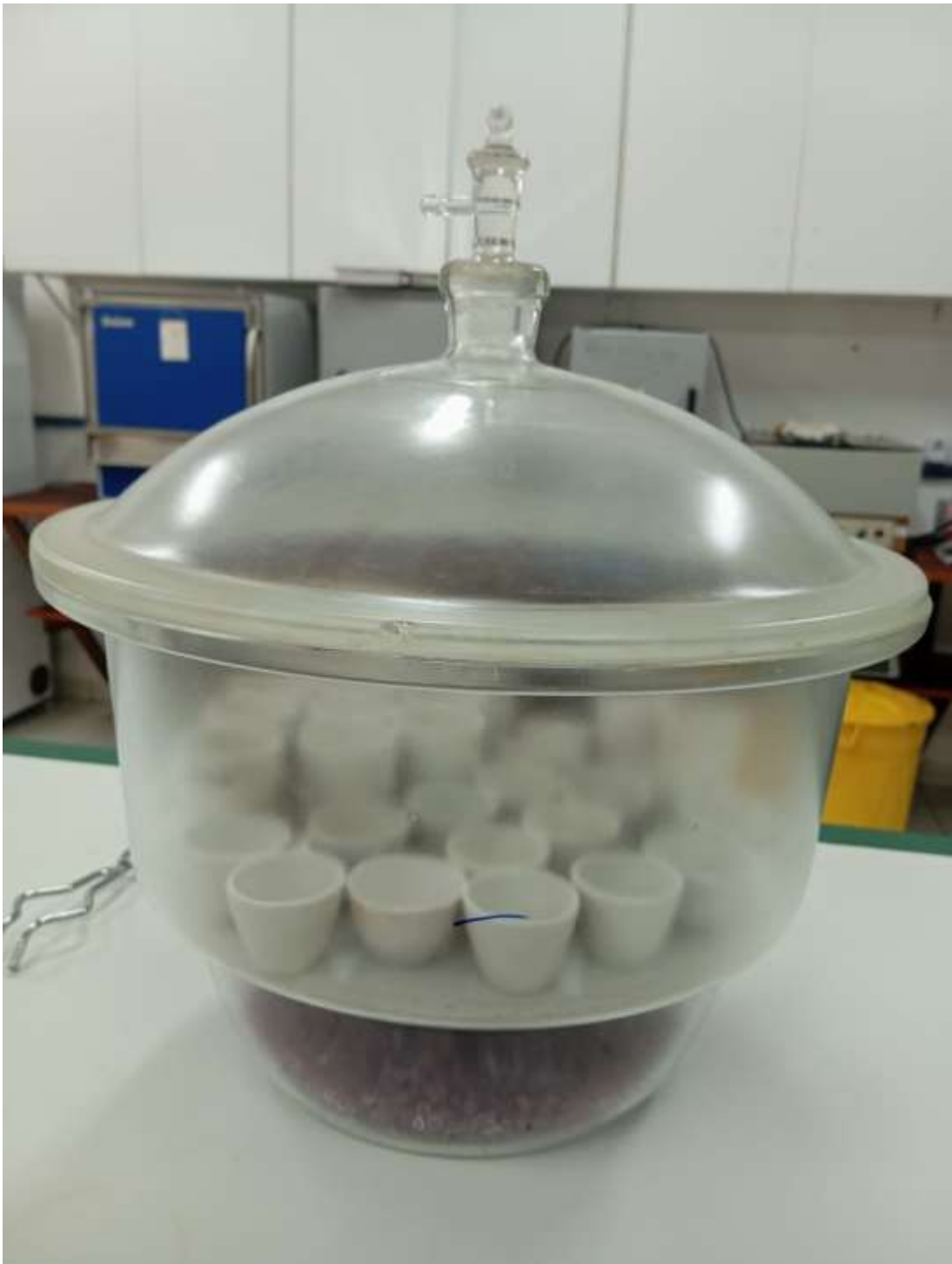
Figura 11 - Dessecador com amostras.
